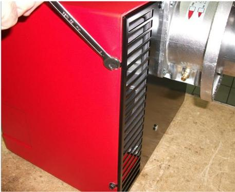
1) Снять кожух, ослабив 4 винта;
