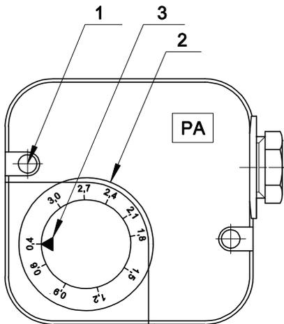
Fig. 13 1-Винт заглушка 2-Регулировочная гайка
