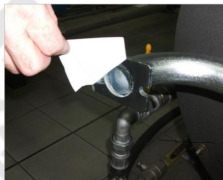
6) Снять заглушку из Труба ГАЗОВОЙ рампы;
