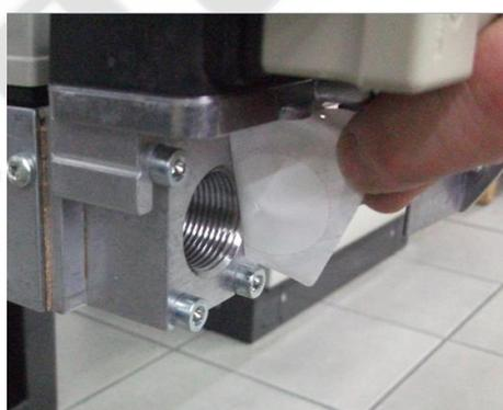
8) Снять заглушку из Труба ГАЗОВОЙ рампы;
