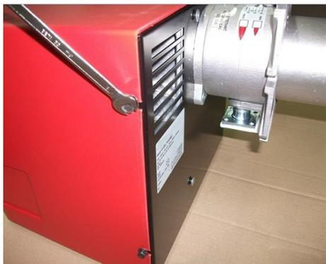
1) Снять кожух, ослабив 4 винта;
