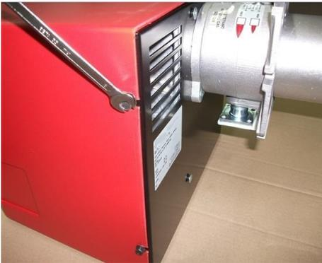
1) Снять кожух, ослабив 4 винта;
