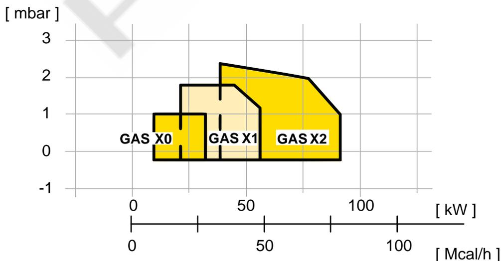
Fig. 1 X = Мощность Y = Сопротивление камеры сгорания
