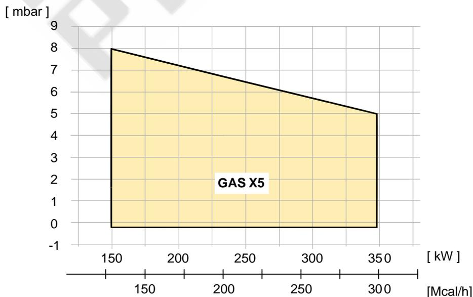
Fig. 3 X = Мощность Y = Сопротивление камеры сгорания
