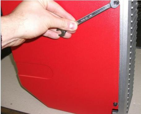
1) Снять кожух, ослабив 4 винта;
