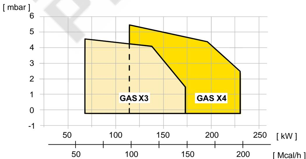
Fig. 2 X = Мощность Y = Сопротивление камеры сгорания
