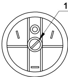
Fig. 14 МОД.SIT: 1- Регулировочный винт
