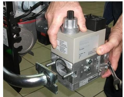
9) установить электроклапан на Труба ГАЗОВОЙ рампы;
