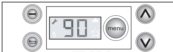
Рис. 3 DBA с гаечным ключом в режиме сервиса
